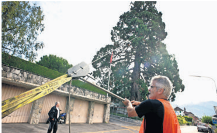
Une machine exerce une traction progressive jusqu'à 1,5 tonne.
